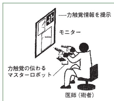
力触覚のある内視鏡外科用支援手術ロボットの概念像 © 大西公平
